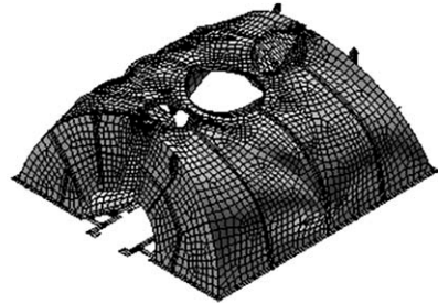
그림 5 저압터빈 outer casing FE 모델
