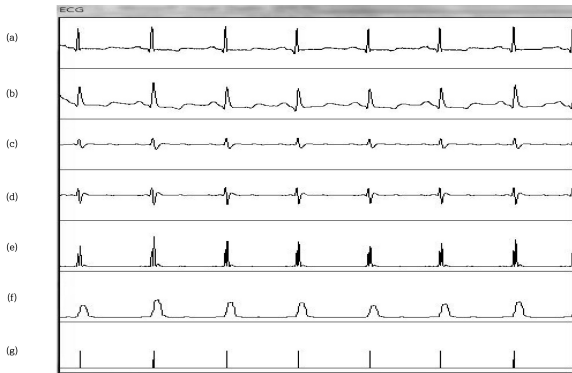
그림 8. 신호 출력 인터페이스 (a)원 신호(b)저대역 통과필터 (c)고대역 통과필터 (d)미분 연산(e)제곱 연산(f)적분 연산 (g)R-peak 위치
