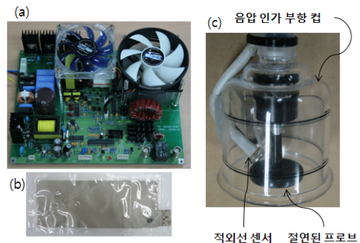
그림 3. 설계된 고주파 자극 시스템 (a)고주파 시스템, (b)절연 플레이트, (c)음압 프로브 Fig. 3. Designed of radio frequency stimulation system. (a)radio frequency system, (b)isolation plate, (c)negative pressure probe
