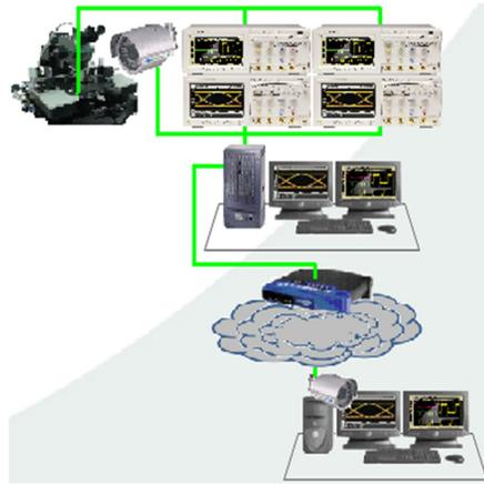
그림 10. 웹 기반 원격공동계측시스템 구성도(ETRI)
