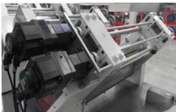
그림 5. 개발된 롤 간격 조정시스템 Fig. 5. The developed roll-gap adjustment system
