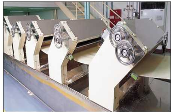
그림 3. 기존의 압연공정용 연속 롤러 Fig. 3. A conventional continuous rolling machine
