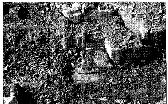
그림 9. 세일층 굴착 후 노출시 급격한 파쇄 및 박리 현상 발생
