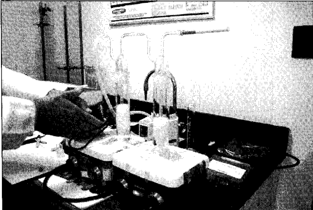
〈그림 2〉 전자담배의 독성검사 장면, 전자담배를 흡입할 때와 동일한 온도조건을 유지한 검사장비로 이용자가 어떤 물질을 흡입하는지 여부를 평가할 수 있다.
