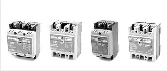
분전반용 기기는 30~100AF까지 DIN Rail 및 나사 부착방식 겸용으로 설계됐으며 프레임 정격별로 배선용 차단기와 누전차단기의 치수 호환성(Twin Type)이 있으며, 소형 경량의 제품으로 분전반 제작에 최적이다.
