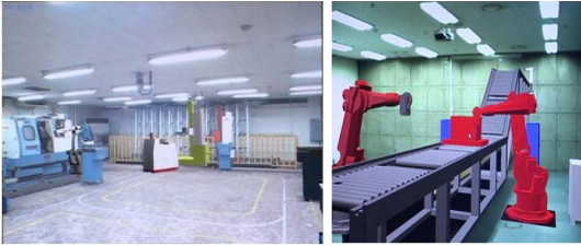
(그림 16) 혼합현실 기반 가상 공정 가시화 사례: AGV 기반 금속 가공 공정(좌) 및 다관절 로봇 기반 제품 포장 공정(우)
