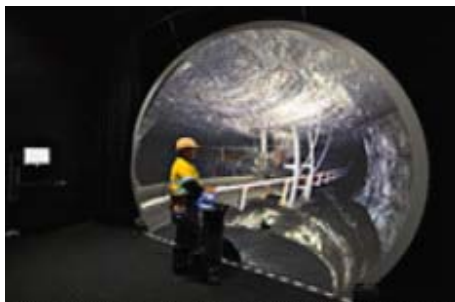
(그림 9) Coal Services Pty의 광산산업 가상환경 훈련 시뮬레이터[12]
