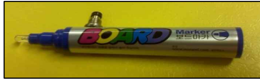
[그림 3] 저비용으로 제작된 적외선 LED 펜
