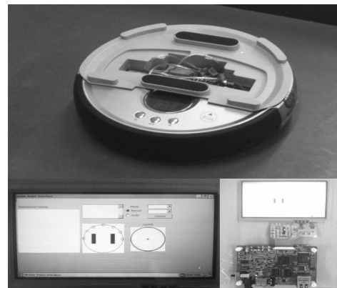
그림 7. 이동로봇 X-BOT(상)과 임베디드 디바이스에서 실행된 사용자 인터페이스 화면(하)
