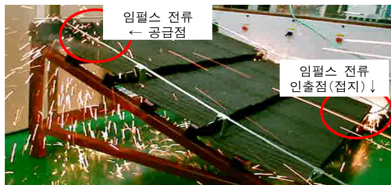
그림 7. 금속기와지붕의 낙뢰 모의 실험 전경 Fig. 7. Overview of impulse experiment of metal roof
