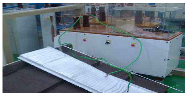
그림 4. 금속기와의 임펄스 내구성 실험 Fig. 4. Experiment of capability to withstand impulsive current of metal roof
