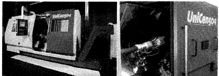
그림 4 선반과 레이저 표면처리장치가 결합된 가공기(MONFORTS 사)
