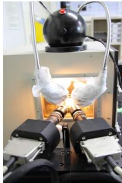
그림 1. ARAMIS와 가열챔버를 이용한 열변형 측정 시스템
