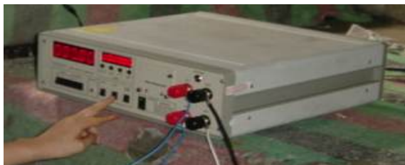
그림 3. 측정에 사용된 정밀저항측정기 Fig. 3. Micro Ohm-meter used to measure the resistance of the steelwork.
