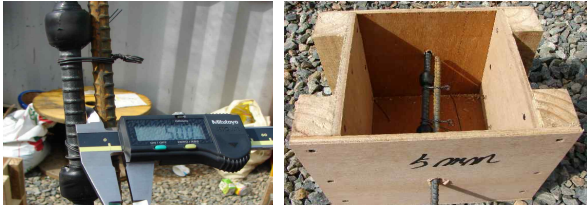
그림 6. 시료의 제작 과정 Fig. 6. Production of Test Specimens
