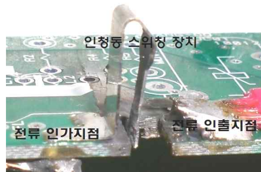
그림 5. 단락전류 차단동작이 완료된 인청동 스위칭 장치 Fig. 5. Phosphorus bronze switching module after short current breaking
