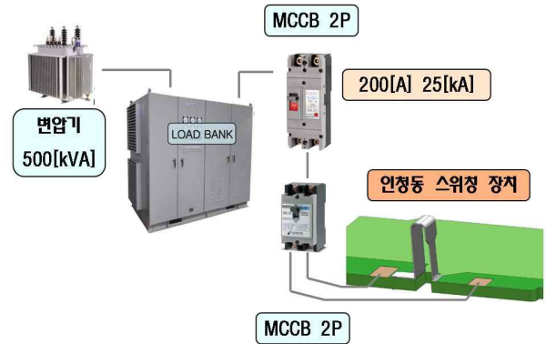
그림 4. 시험장치의 개략도 Fig. 4. A schematic diagram of the test apparatus
