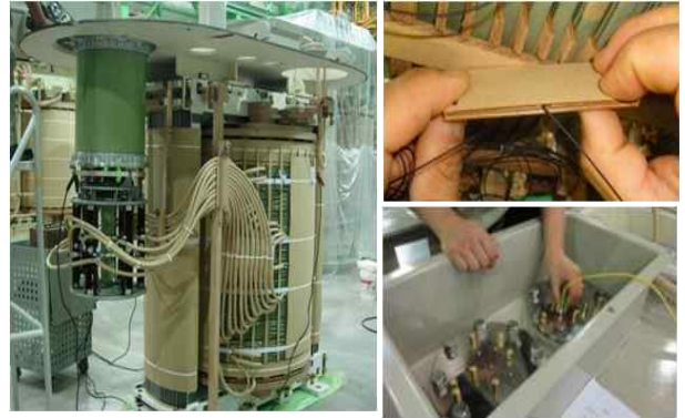
그림 2. 시험을 위해 제작된 변압기 및 센서 Fig. 2. Power transformer and sensor for test
