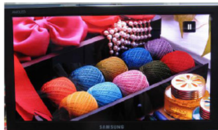
[그림 1] IGZO TFT로 구동한 플렉시블 AMOLED(좌:LG 전자, 2007)와 HflnZnO TFT로 구동한 14" AMOLED(우: SMD, 2011)
