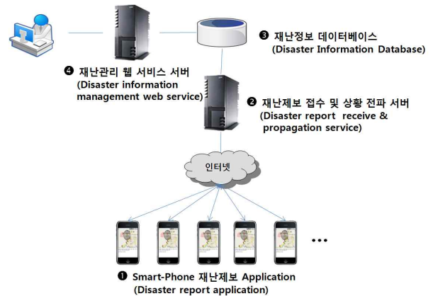
[그림 2] 스마트 폰 기반 재난감시 및 상황전달시스템의 구성요소
