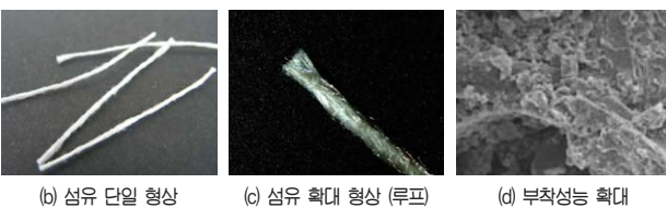
그림 3. 다발형 폴리아미드섬유의 형상 및 특성
