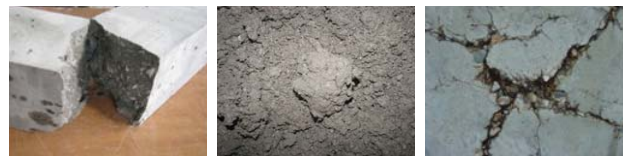
(a) 분산 및 부착성능 불량 (b) 반발률 과다 (c) 부식 발생
