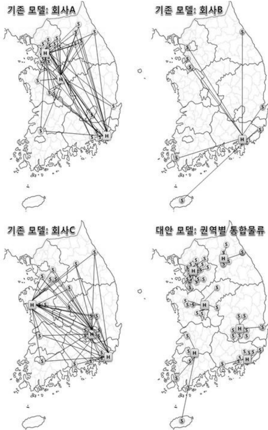
[그림 1] 기존 모델과 대안 모델의 물류센터 및 지점 위치
