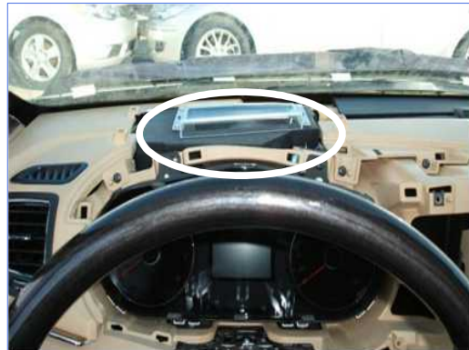
그림 11. 실제 차량에 장착된 통합스마트 시스템. Fig. 11. Intelligent integrated smart monitor system in vehicle.
