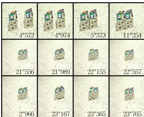
그림 17. 모듈의 자동 결합과 애벌레 동작 Fig. 17. Self-assembly and inchworm motion
