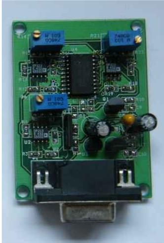
그림 4. 제작된 자기센서모듈의 회로기판 및 실장부품
