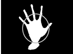
그림 2. 원을 이용한 손가락 수 검색 이미지 Fig. 2. Searching fingers using circle
