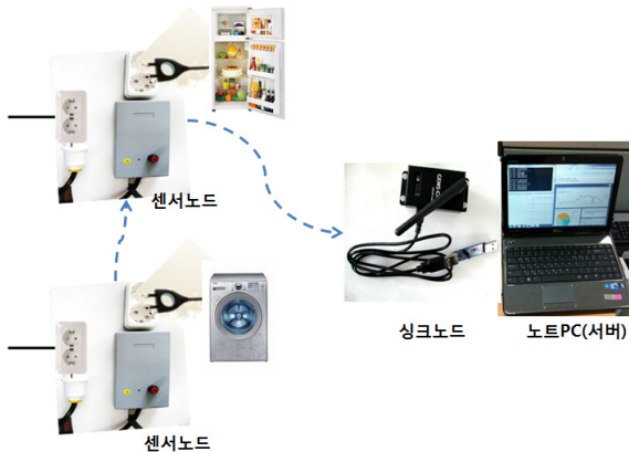
그림 1. 전력 모니터링 시스템 구성 (좌측: 기기의 전원 케이블과 연결할 수 있고 무선통신이 가능한 센서노드; 중앙: 센서노드로부터 신호를 수신하여 서버로 전달하는 싱크노드; 우측: 서버역할을 하는 노트 PC)
