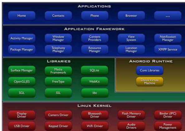
그림 1. 안드로이드 구조 Fig.1 Android Architecture
