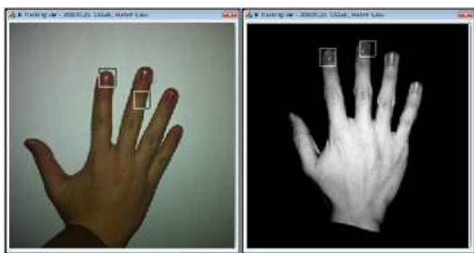
그림 11. 실외(야간)에서의 적외선 영상과 일반 영상 시스템 비교 실험 결과
