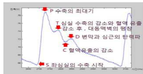
그림 5. PPG 신호의 센서 파트 Fig. 5. PPG signal parts of the sensor
