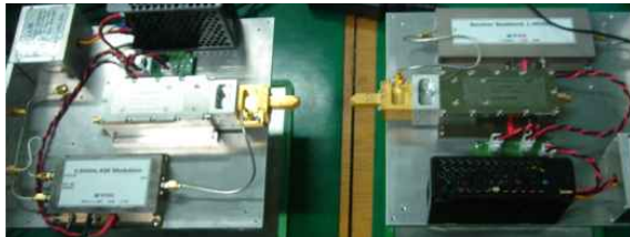
그림 10. 무선 전송 시험을 위한 측정 Set-up Fig. 10. Measurement Set-up for wireless transmission test
