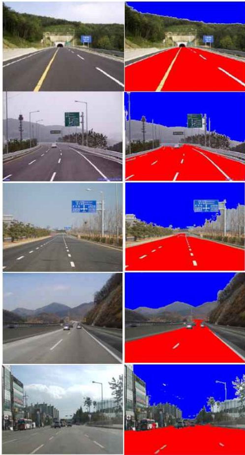
(a) 입력영상 (b) 결과영상 그림 9. 제안된 방법에 의한 도로/하늘 분할 결과 영상 Fig. 9. Road/sky segmentation result using the proposed method
