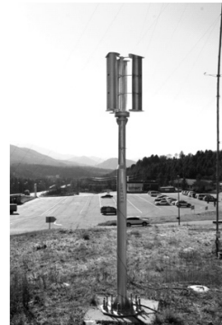
[그림 3] 200W 소형풍력발전시스템(GWE-200BI)
