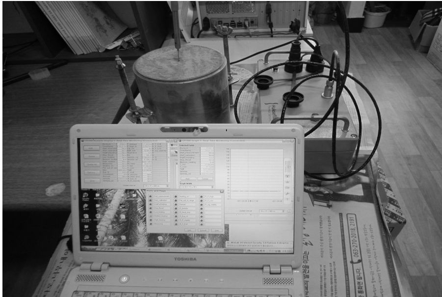
사진 3. TP System을 사용한 열저항률 측정
