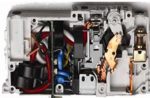
그림 2. 데이터가공 및 통신기능을 갖는 차단기 구성 Fig. 2. Circuit Breaker composition of data analysis and transmission function
