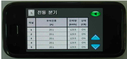
그림 6. 상태보기(전등분기) Fig. 6. Situation conformation by smart phone monitoring system
