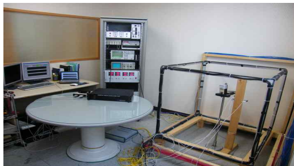
그림 4. 교류 자기장 상쇄 측정 시스템 Fig. 4. Measuring system for AC magnetic field compensation
