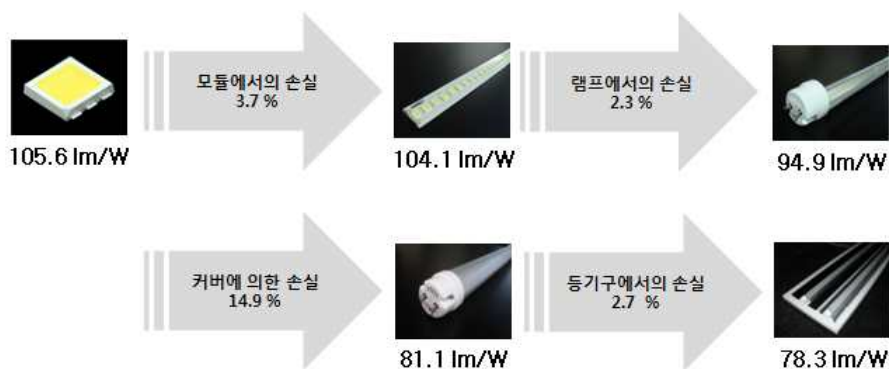
그림 5. 직관형 LED램프의 구성부품별 광손실 Fig. 5. Optical Losses of Tubular LED Fluorescent Lamps Components
