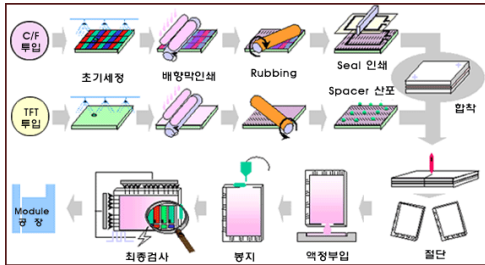
그림 1 TFT-LCD 제조공정 Fig.1. Manufacturing Process of TFT-LCD
