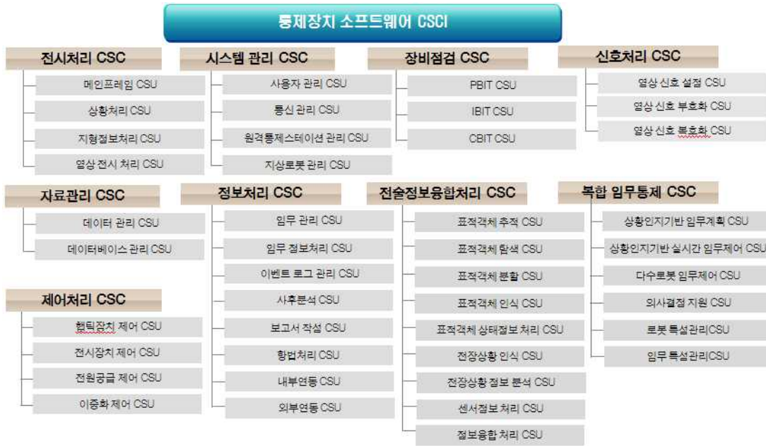
그림 8. 통제장치 소프트웨어 구성항목 Fig. 8. Computer software configuration item for remote control station
