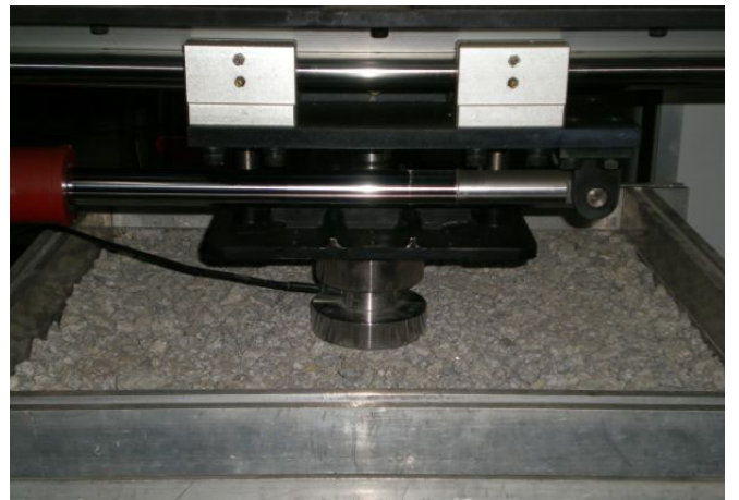
그림 12. Wheel load simulator 장비를 이용한 평판재하시험
