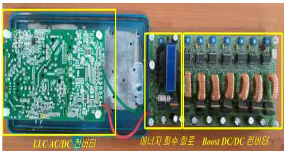
그림 8. 제안된 LED Power System Fig. 8. Proposed LED Power System
