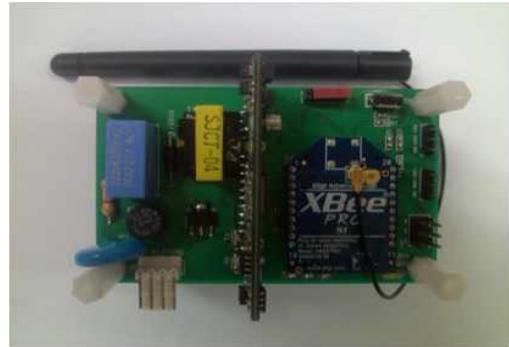
그림 3. 구현된 XBee_PLC 보드 Fig 3. Implemented XBee_PLC board.
