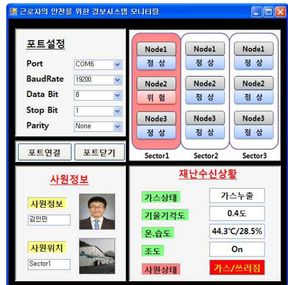
그림 4. 구현된 모니터링 시스템 Fig 4. Implemented monitoring system.
