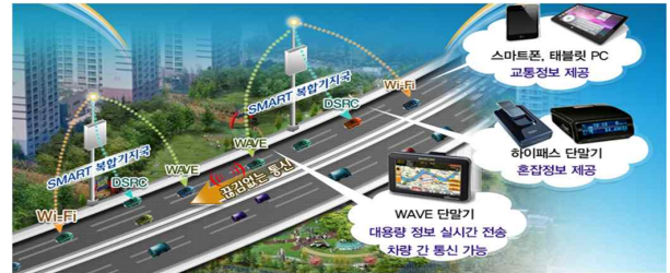
그림 1. 스마트 하이웨이에서의 복합기지국 Fig. 1. a Complex Base Station in SMART Highway
