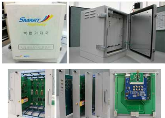
그림 7. WAVE 통신 시스템 구성 Fig. 7. Composited WAVE Communication System
