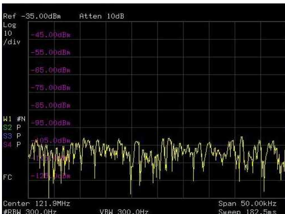
그림 4. 121.9 MHz 스펙트럼 분석 Fig. 4. Spectrum analysis of 121.9 MHz
