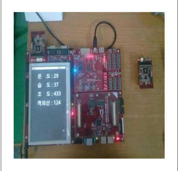
그림 19. 온도, 습도, 조도, 적외선 센서 화면 Fig. 19. View of temperature, humidity, illumination, infrared ray sensors.
