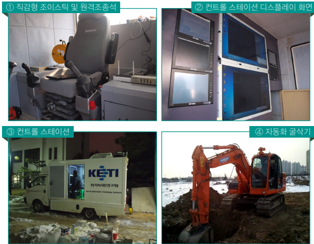
[그림 8] 이동형 컨트롤 스테이션 및 자동화 굴삭기
