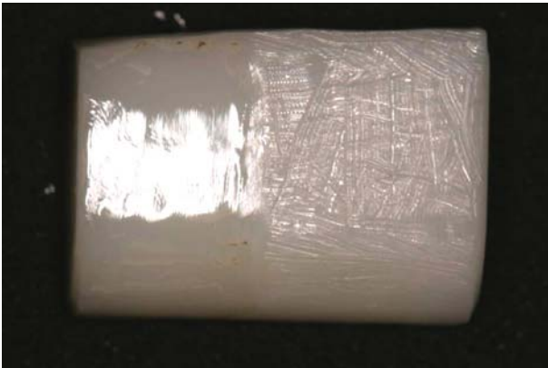
Fig. 23. 그 부위를 diamond impregnated wheel로 polish 하니 매끄러워져서 광택이 난다.
