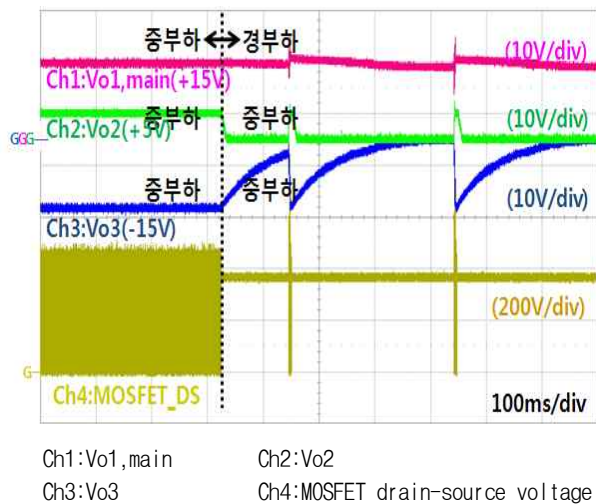
그림 2 Burst mode로 인한 출력전압 감소파형 Fig. 2 Waveform of output voltage drop caused by burst mode
