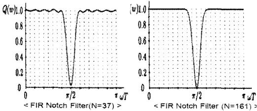
그림 4. 차수에 따른 FIR Notch Filter 성능 비교
