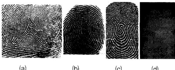
그림 3. 지문 획득 방식, (a) 날인 지문, (b) 놀린 지문, (c) 스와이프(swipe) 지문, (d) 비접촉식 센서 지문
