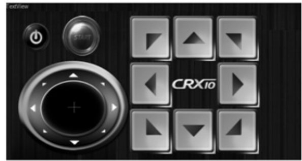
그림 4. 트랙볼 제어 및 각 방위 버튼을 이용한 주행제어 Fig. 4. Track Ball and Direction Buttons for Mobile Robot Remote Control
