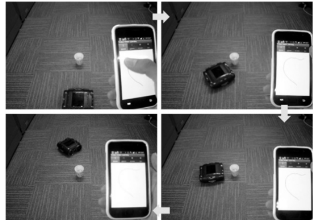
그림 7. 터치 기반 이동로봇 주행궤적 생성 및 로봇의 궤적 추종 실험 Fig. 7. Touch-based Moving Trajectory Generation and Mobile Robot Navigation Experiment
